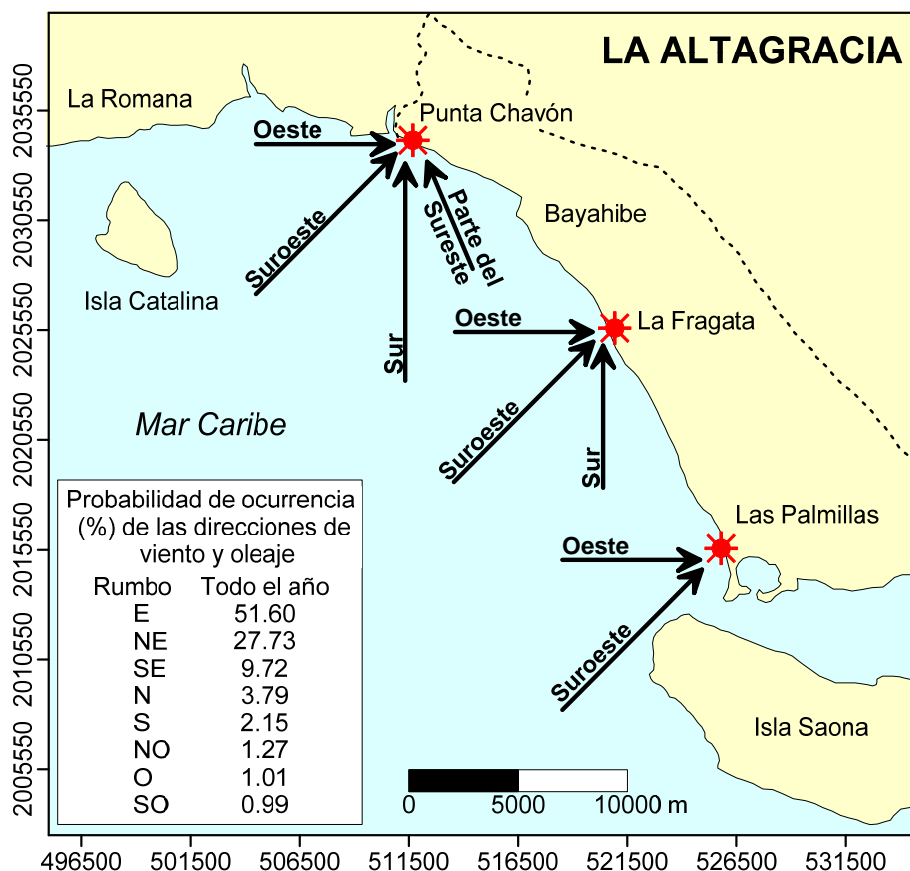
Figura 5. Rumbos de oleaje de mayor incidencia en tres puntos de la costa del Distrito Municipal Bayahibe. Al Norte la costa está afectada por las olas del Oeste, Suroeste y Sur (probablemente parte del Sureste), hacia el Sur se mantiene la influencia de olas del Oeste y Suroeste, pero se reduce la influencia del oleaje del Sur.
