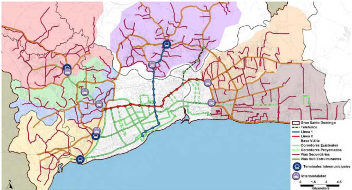
Ilustración 60 –Principios de estructuración para el diseño de una red de bus
