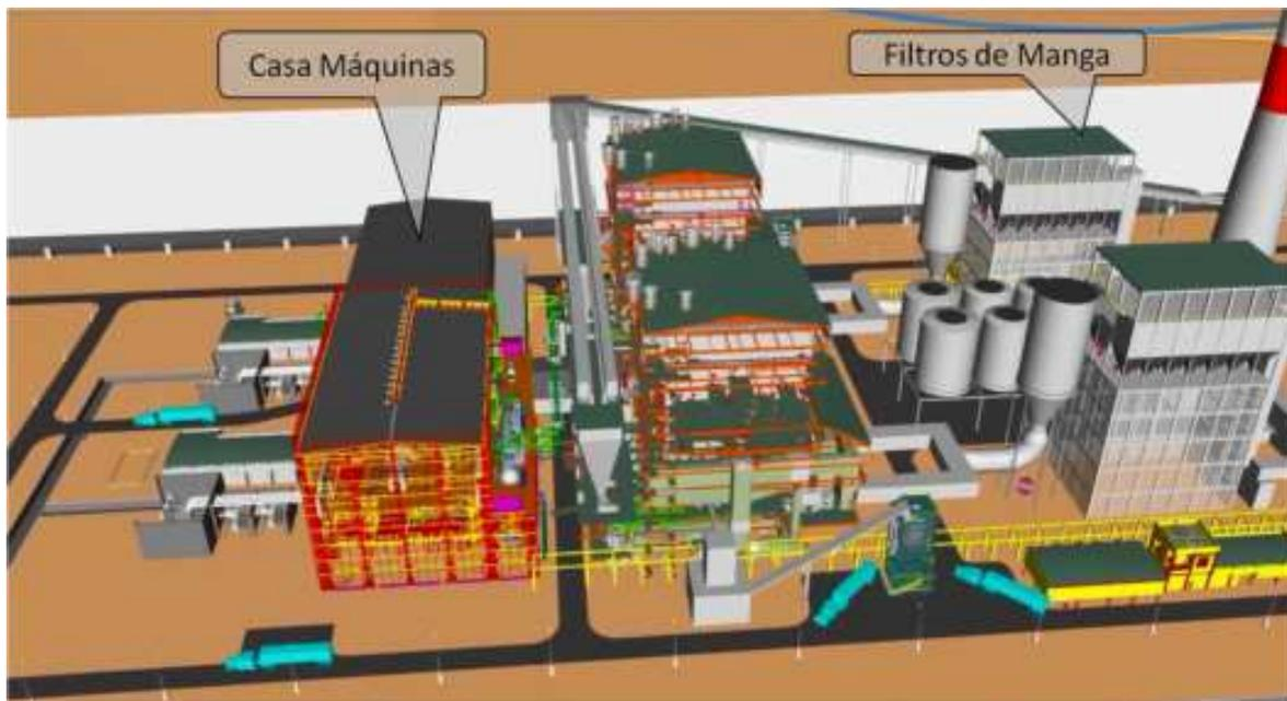
**Figura 3-8. Se muestra parte de los componentes de la Central Termoeléctrica**
