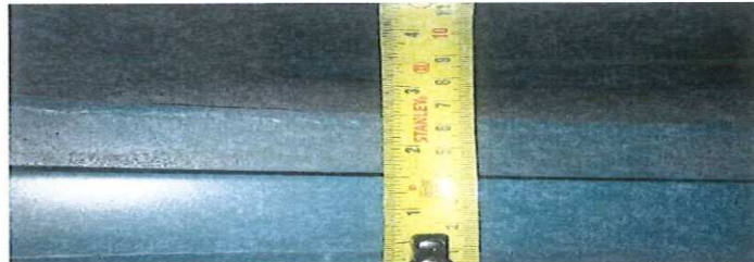
Figura 3-8 — Desalineación del ventilador de aire de sellado
