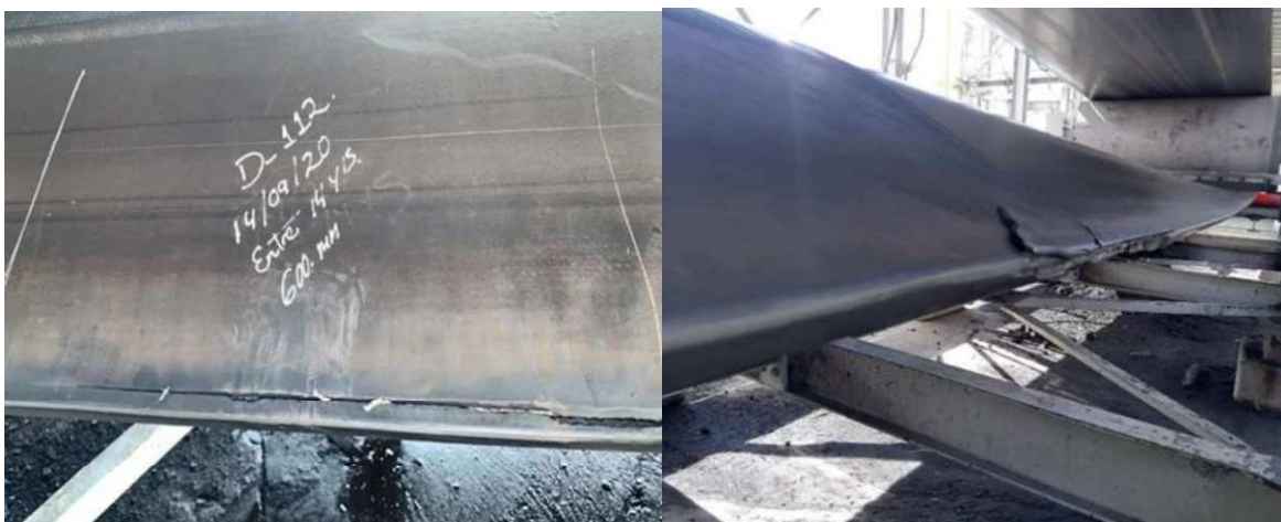
Figura 3-4 — Falla recurrente en el borde de la cinta luego de cada entrega de carbon
