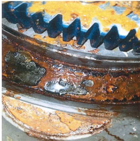
Figura 3-2 — Condición del engranaje del clasificador rotatorio
