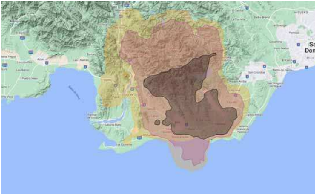
Figura 11. Concentraciones máximas horarias estimadas de SO 2 en el escenario "worst". Los gráficos de contorno indican áreas con valores más altos de 80 - 100 (amarillo), 100 - 196,5 (naranja) y por encima de 196,5 (negro) µg/m 3
