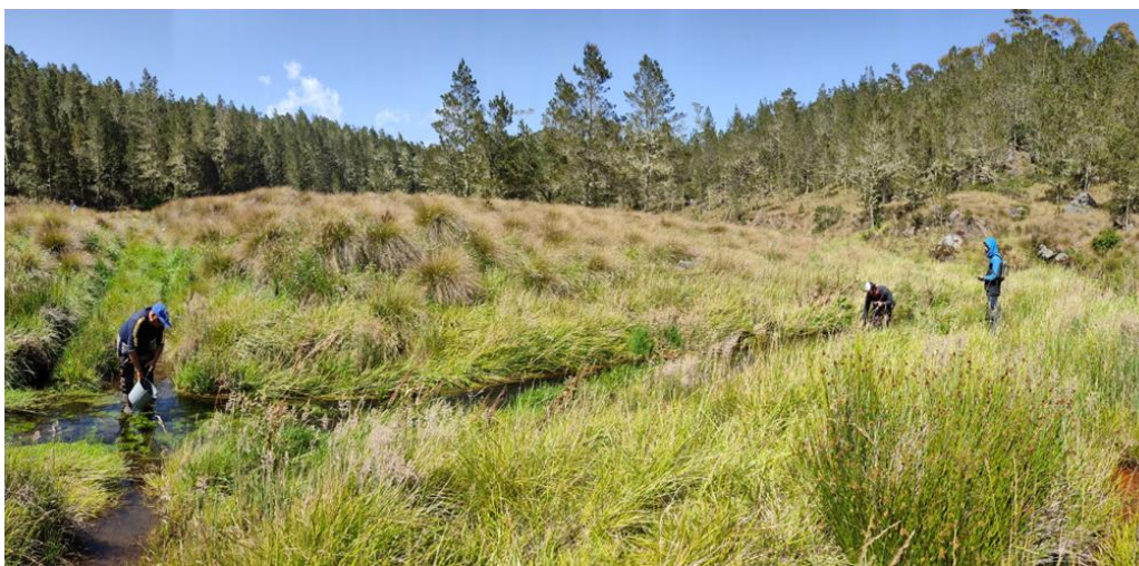
Figura 5. Medición de caudales con el método de salinidad (sensor EasyFlow) en nacientes de la cuenca del Río Nizao
