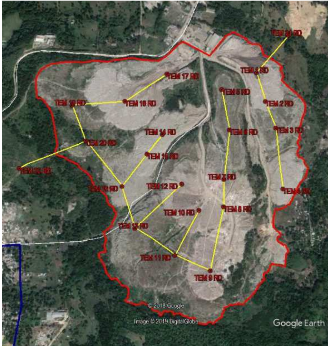
Figura 5.2.2.1.a Localización de sondeos y perfiles geofísicos
