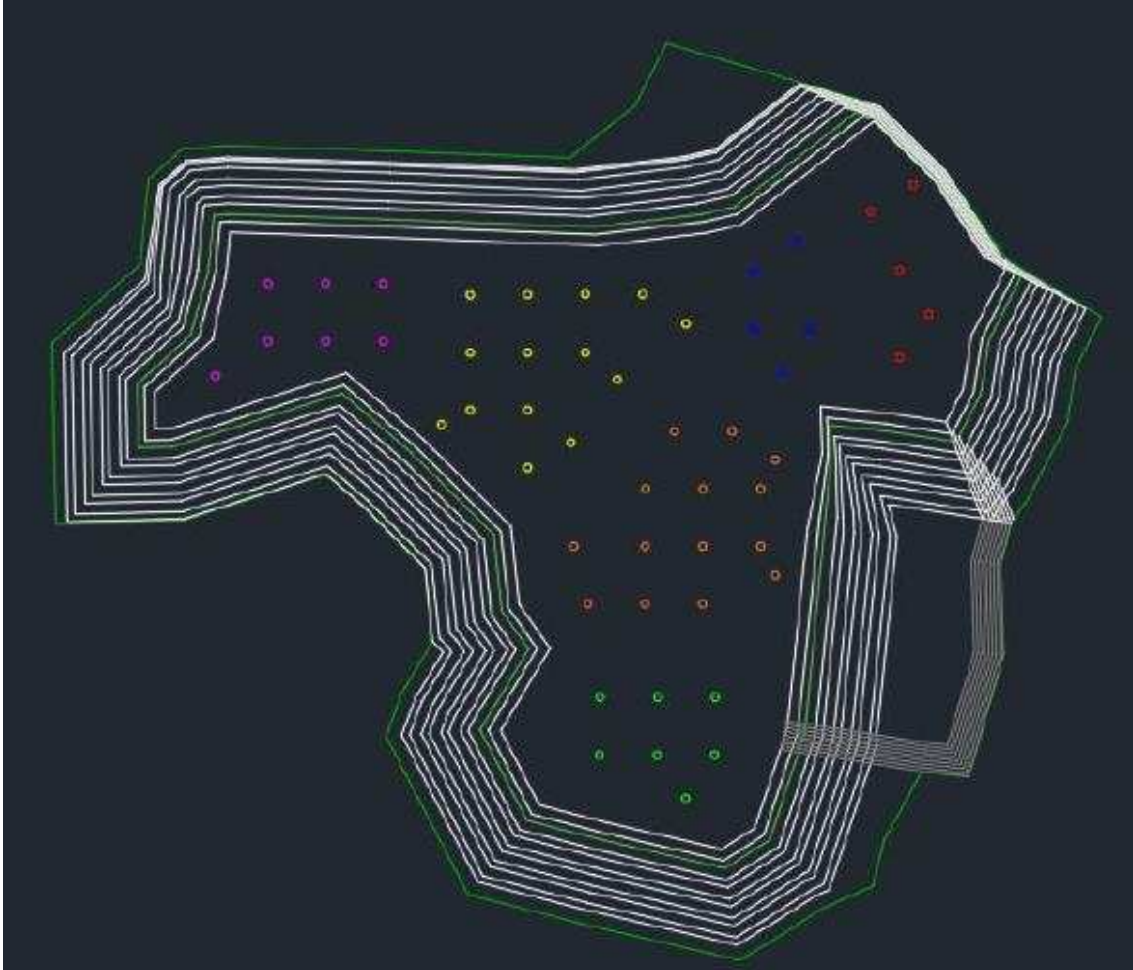
Figura 3.8.4.a Ubicación de los dispositivos de reinfiltración de lixiviados
