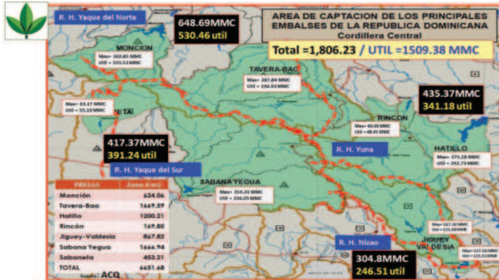
Imagen #1: Embalses ubicados en la Cordillera Central y su Capacidad de almacenamiento total y útil por región hidrográfica.
