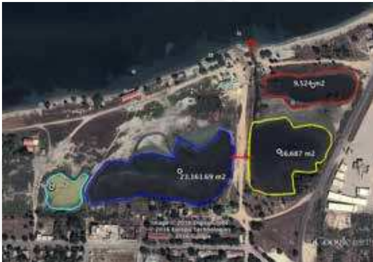
Lagunas de descarga de las aguas residuales Los Barrancones
