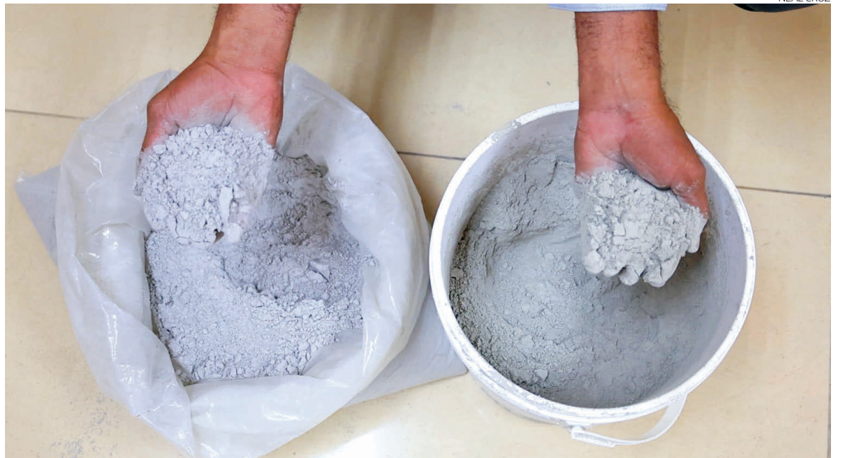
A la izquierda, cenizas de Punta Catalina; a la derecha, cemento con las cenizas integradas en su constitución.
