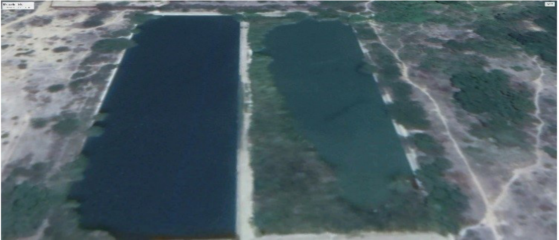
Figura 7. Sistema de lagunas antropogénicas de estabilización-oxidación “El Cardonal”.
