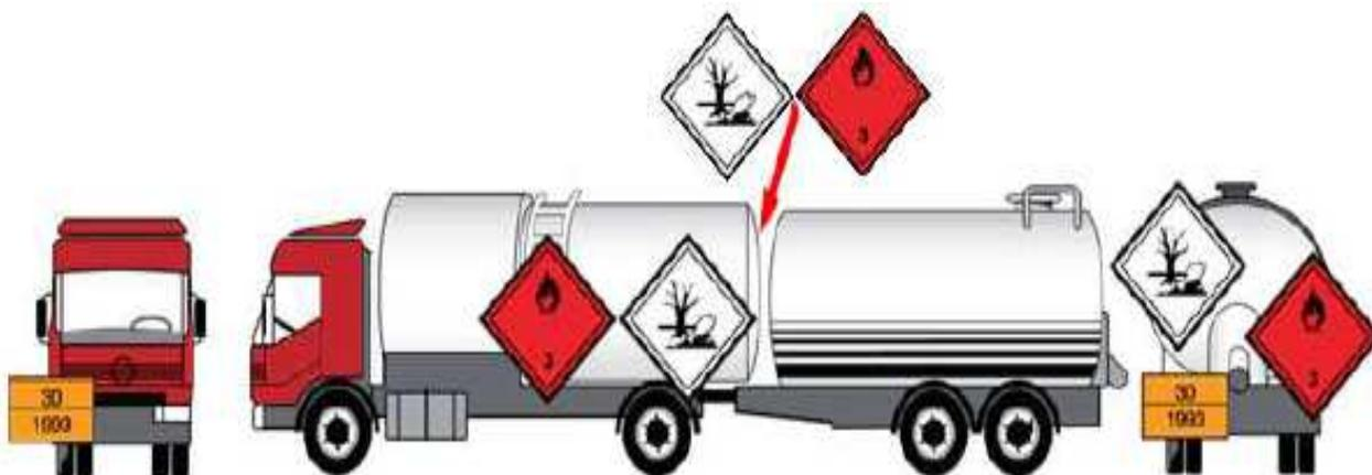
Si una cisterna monocuba transporta una mercancía peligrosa y el remolque no lleva una mercancía peligrosa o va vacío y limpio, se colocan en la parte posterior del remolque sólo las placas-etiquetas de la cisterna.
