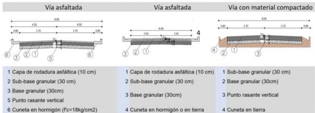
Figura 41: Secciones típicas para los caminos de acceso y vías de mantenimiento. -
