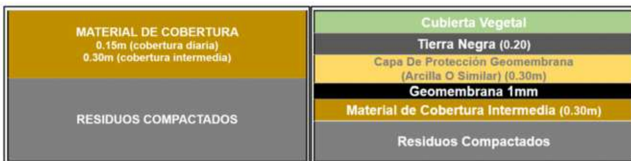
Figura 39: Esquema de la cobertura diaria e intermedia (Izquierda) y cobertura final (derecha)
