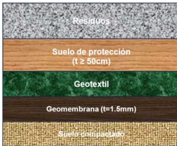
Figura 35: Esquema del Sistema de impermeabilización requerido en cada celda
