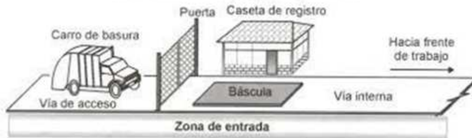
Figura 4. Distribución área de entrada del SDF
