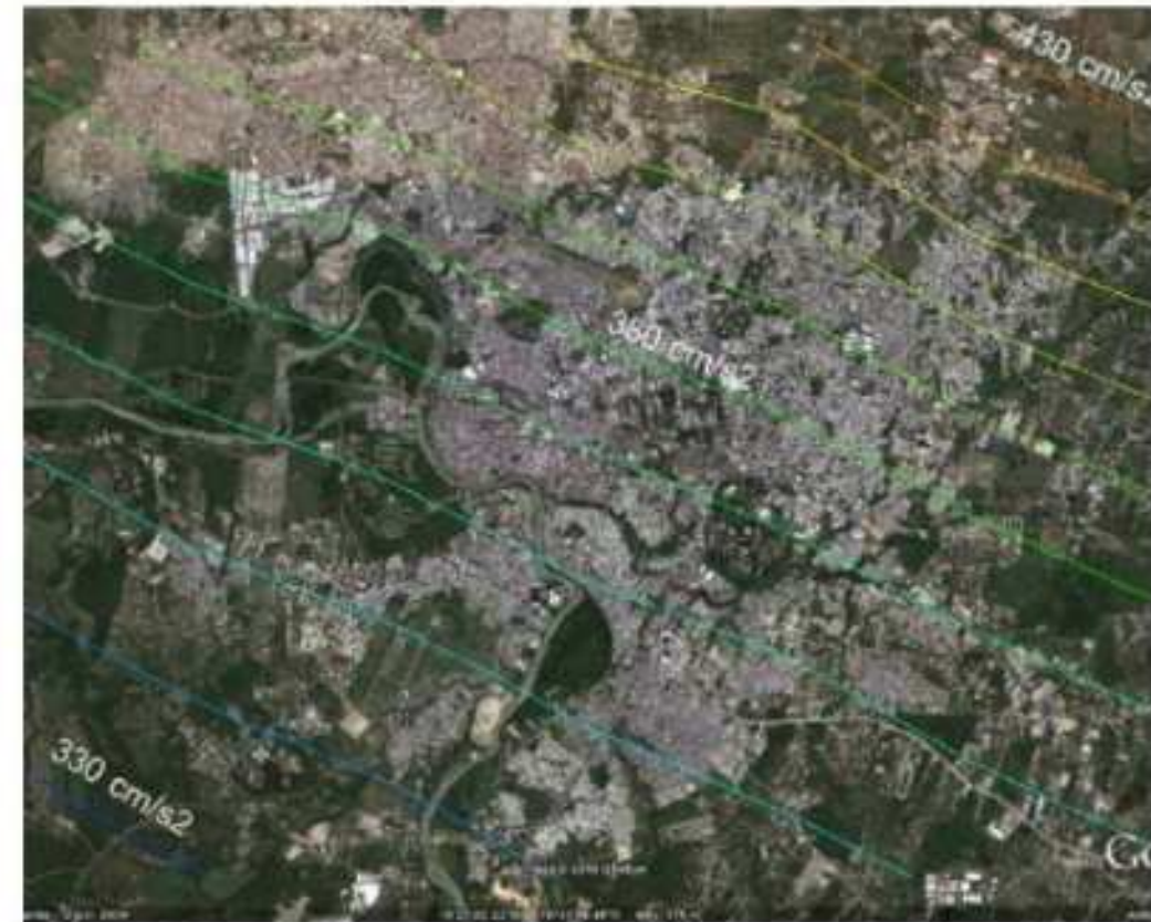
MAPA DE ISO-ACELERACIONES PGA DE LA CIUDAD DE SANTIAGO (T = 475 AÑOS). LAS LÍNEAS ESTÁN ESPACIADAS CADA 10 CM/S 2 , ENTRE 330 CM/S 2 AL SO Y 430 CM/S 2 AL NE
