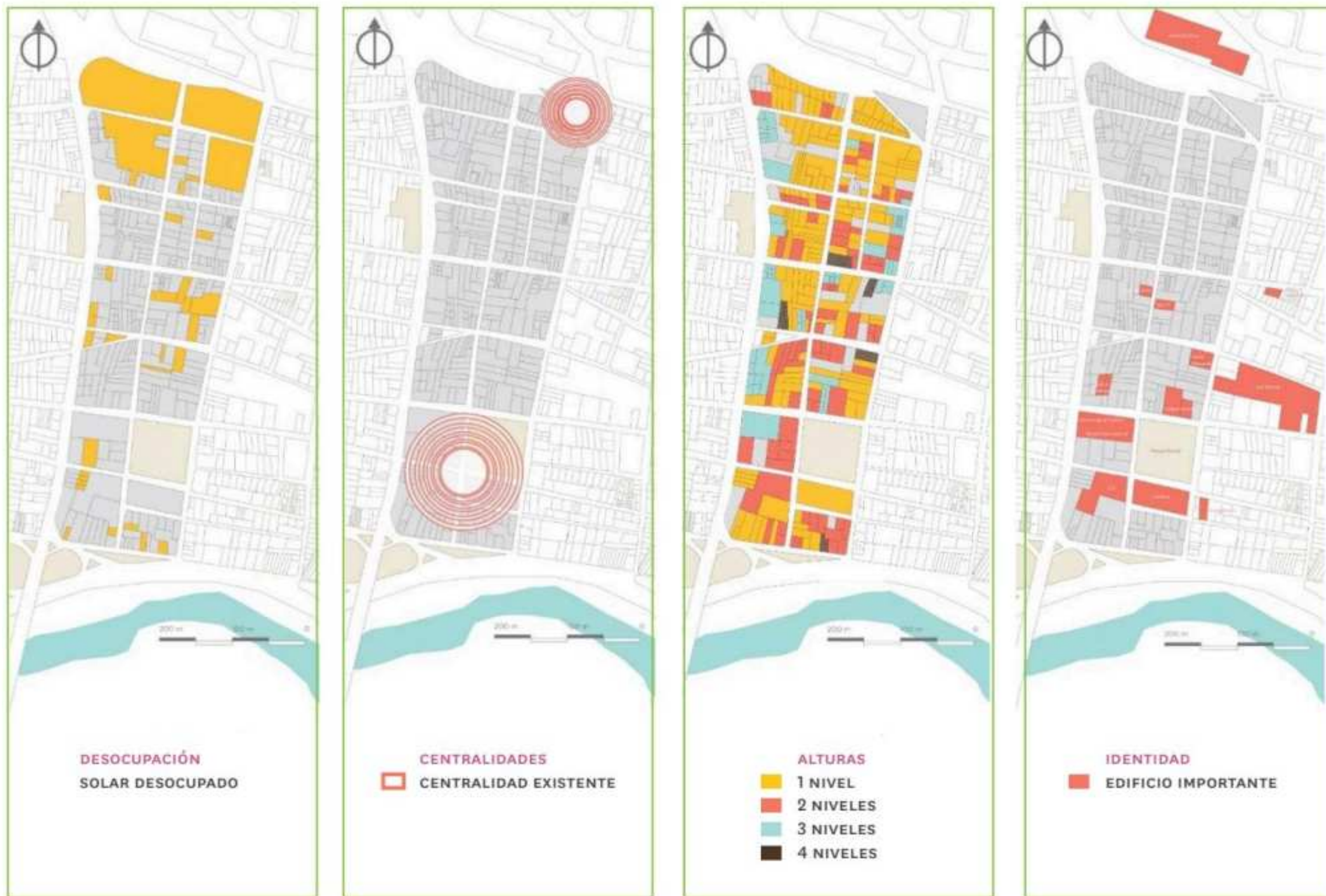
FIGURA 105. PROYECTO PILOTO BENITO MONCIÓN - ANÁLISIS DE ACUERDO A: A) DESOCUPACIÓN, B) CENTRALIDADES EXISTENTES, C) ALTURAS DE LAS EDIFICACIONES, D) IDENTIDAD CULTURAL.
