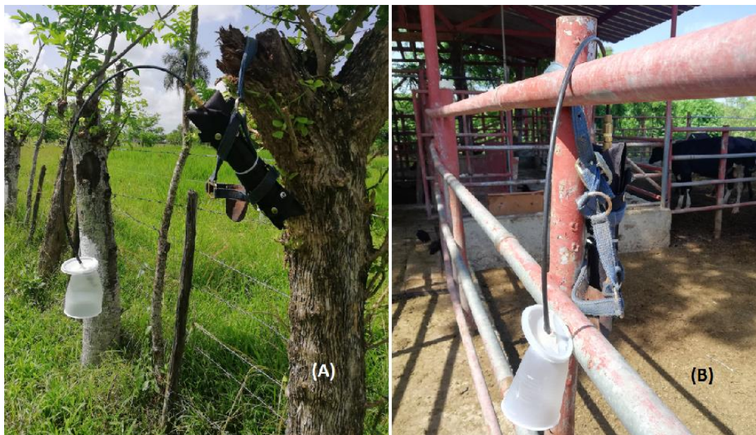
Figura 5. Sistema completo de colección de CH 4 entérico instalado en las novillas, elaborado por los autores.
