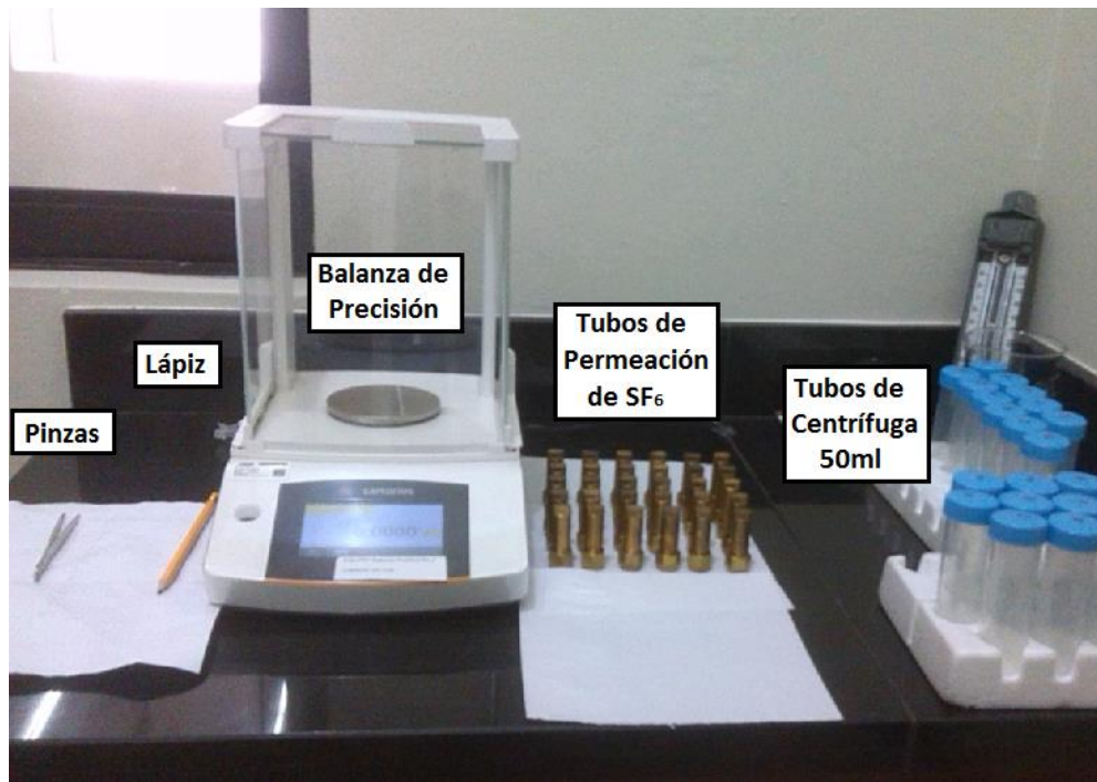
Figura 1. Entorno de pesaje de los tubos de permeación de SF 6 (Fuente: elaboración propia).
