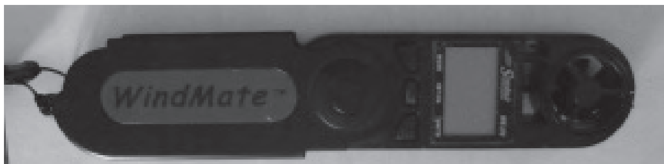
Figura 2. Nanómetro para medir datos de temperatura media, velocidad y dirección del viento.
