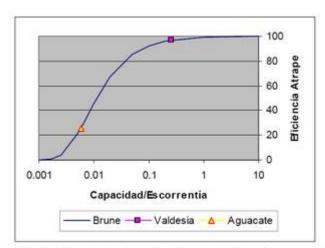
Figura 7 Estimación de eficiencia de atrape de sedimentos (ajuste a la curva empírica de Brune)
