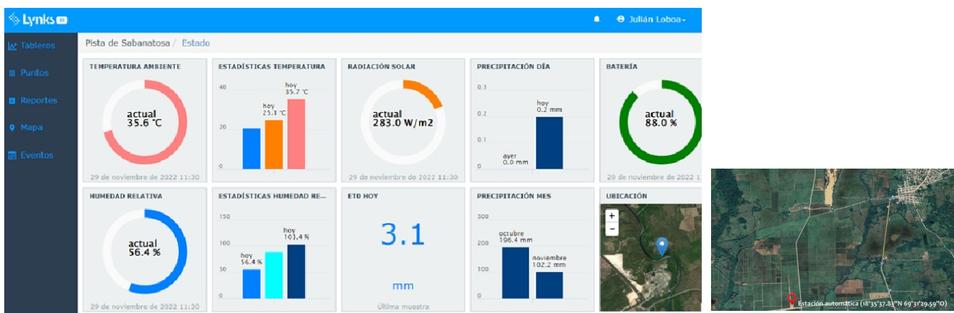
Ubicación de la estación automática del CAEI (derecha) y ejemplo de visualización de datos en línea (izquierda).
