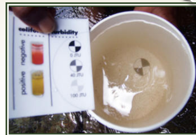
Probando la turbiedad de con "El Malefín Verde de Bajo Costo para Vigilar el Agua"
