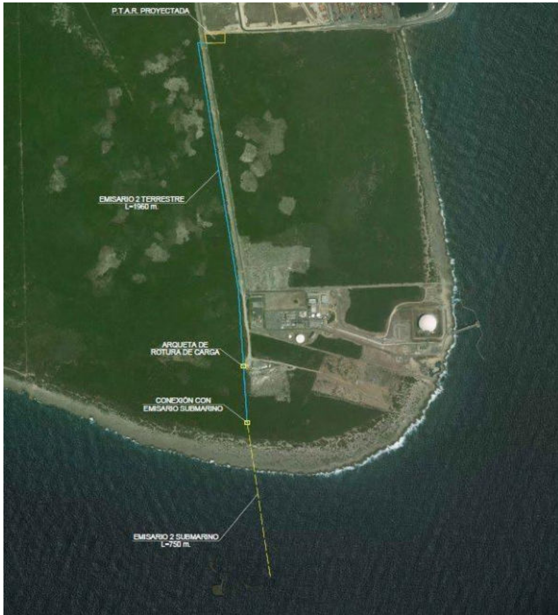
Figura 4.3.4.a Planta del emisario de la PTAR
