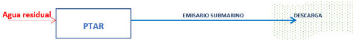
Figura 4.3.3.b Diagrama de flujo de la línea de tratamiento
