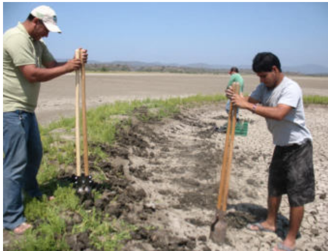
Foto 21. Elaboración de las perforaciones a tres niveles con pala pocera en la terraza de Herradura.
