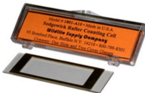
Figura 17. Cámara de conteo tipo Sedgewick-Rafter con portaobjetos de vidrio y tapa de cubreobjetos.
