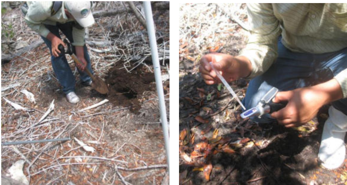
Fotos 7 y 8. Toma de muestra de salinidad intersticial con un refractómetro.
