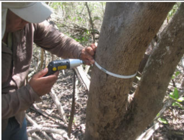
Foto 10. Inmovilización de un extremo del fleje y como referencia cero con un tornillo.
