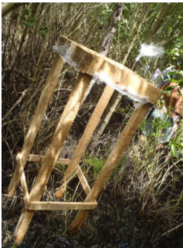
Foto 13. Canastilla de defoliación para determinación de producción de hojarasca.
