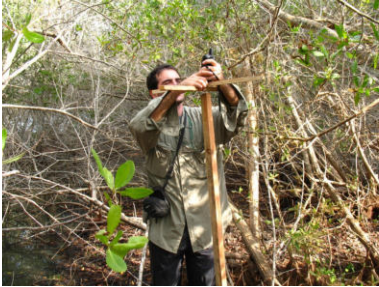
Foto 1. Cruceta proyectando 4 planos convergentes a un punto central y su georeferenciación con un GPS.
