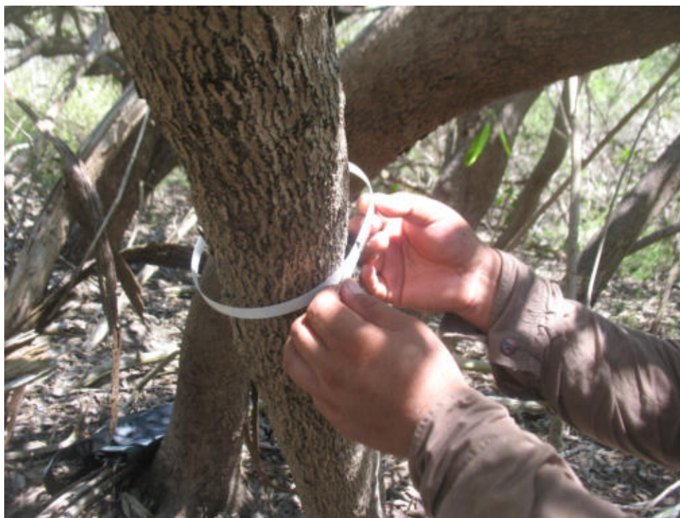
Foto 9. Instalación de un dendrómetro con fleje plástico y abrazadera de plástico.
