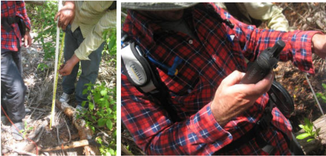
Fotos 5 y 6. Determinando la distancia vertical de la marca “0” de referencia al suelo y marcando el punto con un GPS.
