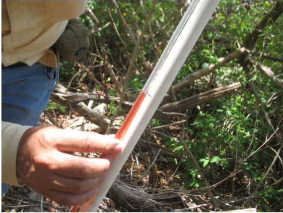
Foto 3. Medición de un estadal mediante un nivel con un tubo de agua para transecto microtopográfico.
