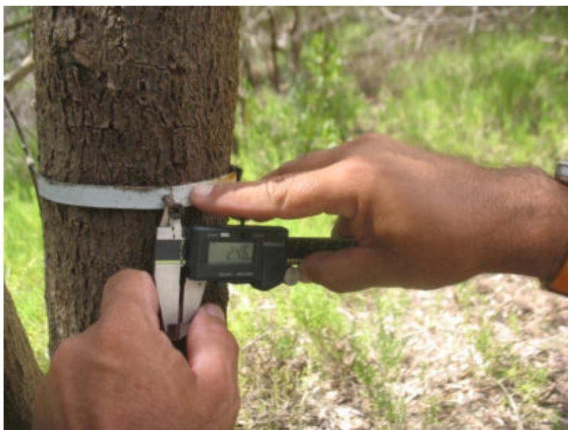
Foto 12. Determinación de aumento de la circunferencia (agosto 2010-marzo 2011) desde el tornillo de instalación (medida cero) a 1 unto de desplazamiento de la cinta plástica.
