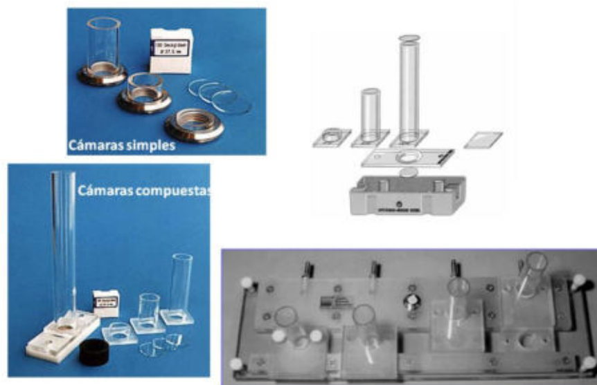
Figura 16. Cámaras de sedimentación para microscopio invertido de 5, 20 y 50 mL y de acrílico con torres desmontables de 10 y 100 mL
