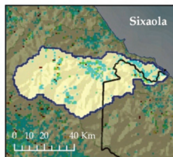
Figura 14. Esta relación A:Q celda por celda identifica cantidades altas de erosión relativa al volumen de escorrentía por km 2 ultimadamente localiza fuentes de sedimentación
