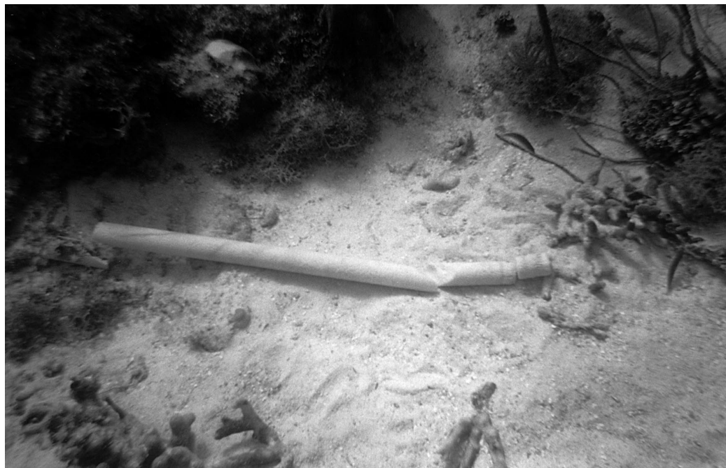
Figure 4-5. Photograph of an extracted core from a Montastraea coral in Parque Nacional del Este. Annual growth is determined by sectioning and x-raying the core to analyze growth bands. Figura 4-5. Fotografía de una muestra testigo extraída de un coral Montastraea en el Parque Nacional del Este. El crecimiento anual se determina seccionando y radiografiando la muestra para analizar las bandas de crecimiento.
