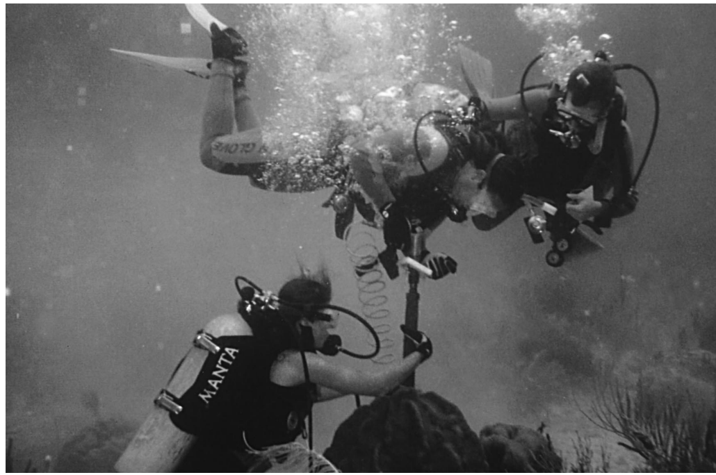
Figure 4-4. Underwater photograph of divers using a hydraulic drill to extract a core from a Montastraea colony in Parque Nacional del Este. The core is used to determine the growth and isotopic composition of the coral over time. Figura 4-4. Fotografía submarina de buzos usando un taladro hidráulico para extraer una muestra testigo o núcleo de una colonia coralina de Montastraea en el Parque Nacional del Este. La muestra se usa para determinar el crecimiento y la composición isotópica del coral a través del tiempo.
