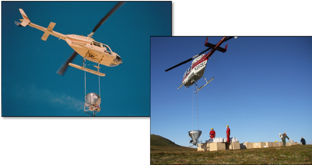
Figura 9. Operación del método aéreo de dispersión de cebo mostrando un contenedor con el cebo colgando por debajo del helicóptero: dispersión aérea de cebo, Isla San Pedro Mártir, México, octubre 2007 (izquierda), y contenedor listo para despegar del sitio de carga de cebo, Isla Rata (ahora llamada Isla Hawadax), Alaska 2008 (derecha).
