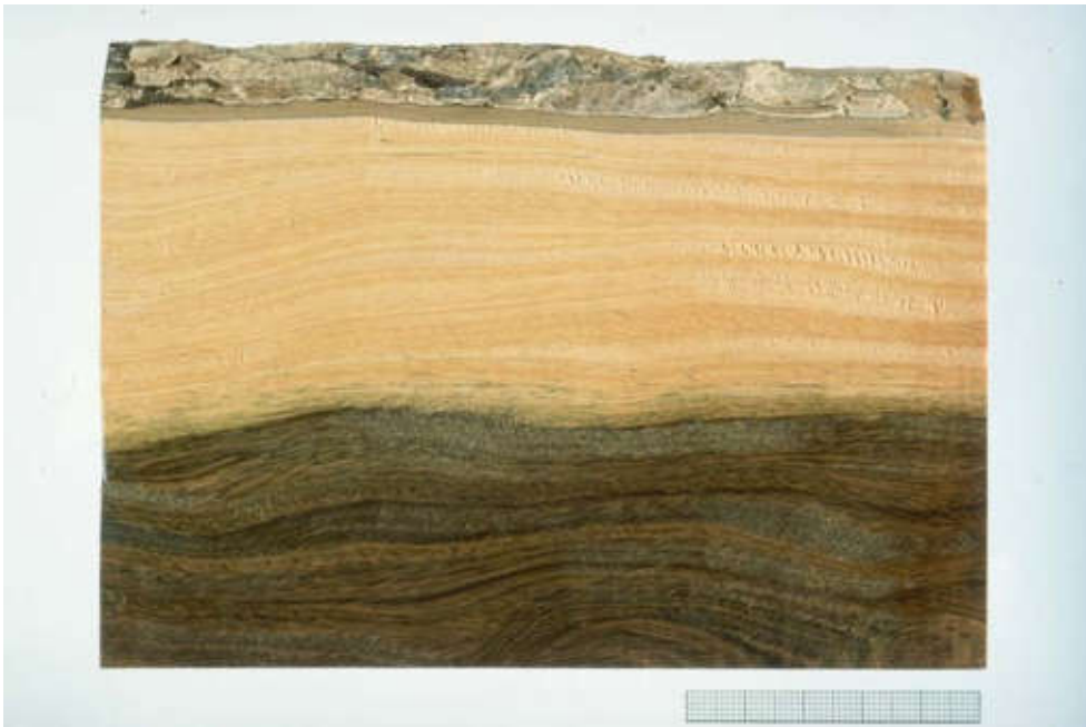
Figura 1. Corte longitudinal de la madera con la corteza, albura y duramen, Guaiaci lignum; especie: Guaiacum sanctum , (copyright BfN).
