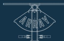
Sistema de seguidores de posición solar (trackers) que giran 104° siguiendo la radiación del sol
