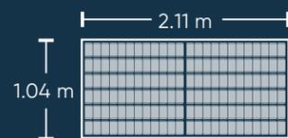
Módulos de 144 células de 430/450 Watts
