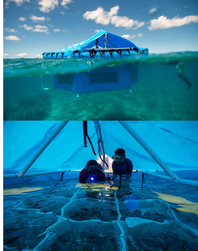
Figura 20. Sistema de cultivo de corales in situ , CRIB, diseñado por SECORE International (Fotos: Paul Selvaggio/PghZoo/SECORE).
