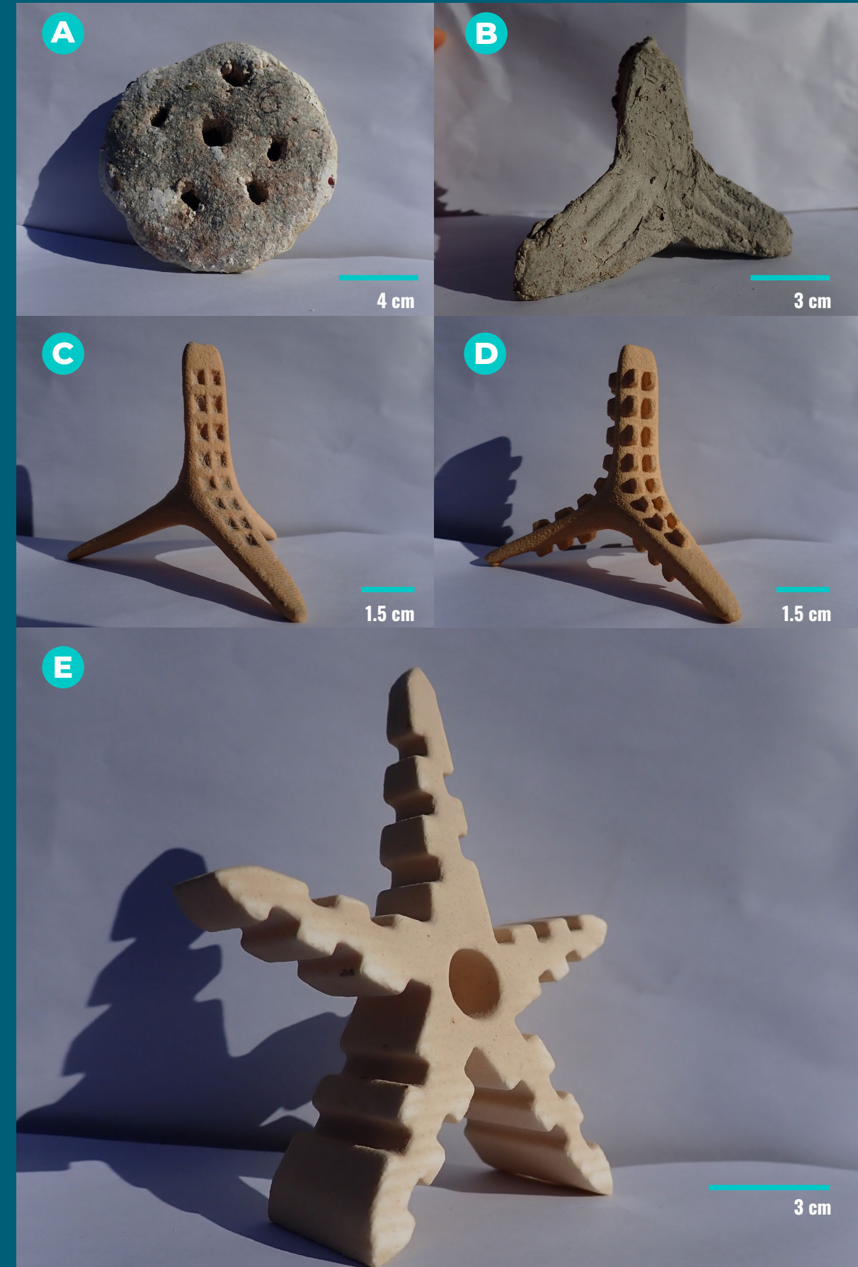
Figura 26. Ejemplo de sustratos usados por FUNDEMAR: A) «galleta» de cemento, así como las diseñadas por SECORE International; B) tetrápodo de cemento; C-D) tetrápodos de cerámica y E) estrella de cerámica (modificado de material suplementario de Sellares-Blasco et al. 2021).
