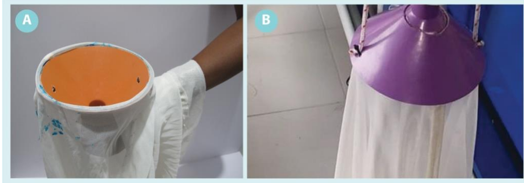
Figura 7. Ensamblado de red. A) Vista interior de la red en medio de los embudos. B) Vista exterior de la red pegada.
