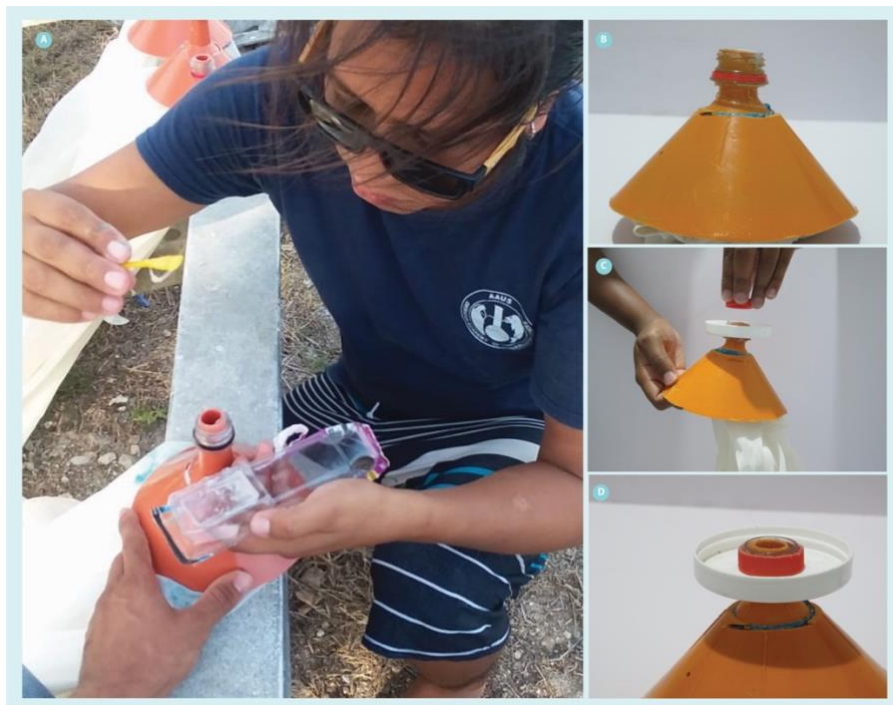
Figura 8. Ensamblaje de la tapa. A-B) Pegado de la parte superior de la botella al embudo. C) Ensamble de la tapa perforada del frasco recolector. D) Aseguramiento de la tapa del frasco recolector y aspecto final.
