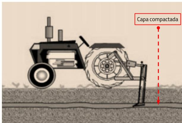
La preparación profunda implica el uso intensivo de implementos que pueden ocasionar erosión por viento y por escorrentías debido a la roturación excesiva. Además, se trata de una labor costosa que necesita una gran potencia tractora y mucho tiempo, por lo cual generalmente se abandona esta práctica en beneficio de otras labores más superficiales y menos costosas que consiguen efectos similares.
