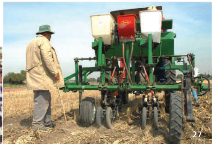
Figura 16. Maquinaria especializada sembrando en un terreno con labranza mínima.
