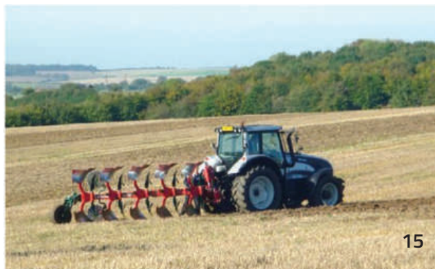
Figura 7. Los aperos agrícolas son herramientas o máquinas que se acoplan a los tractores gracias a un sistema de enganche.
