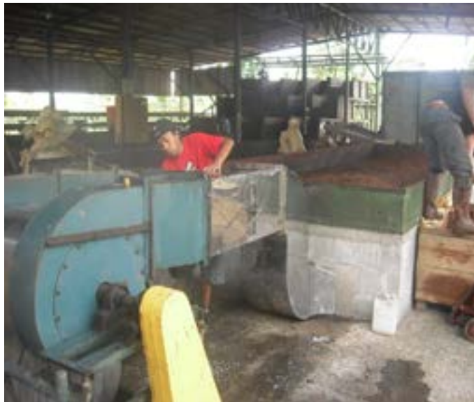
Figura 60. Secador artificial de semillas de cacao. Foto: O. Brenes
