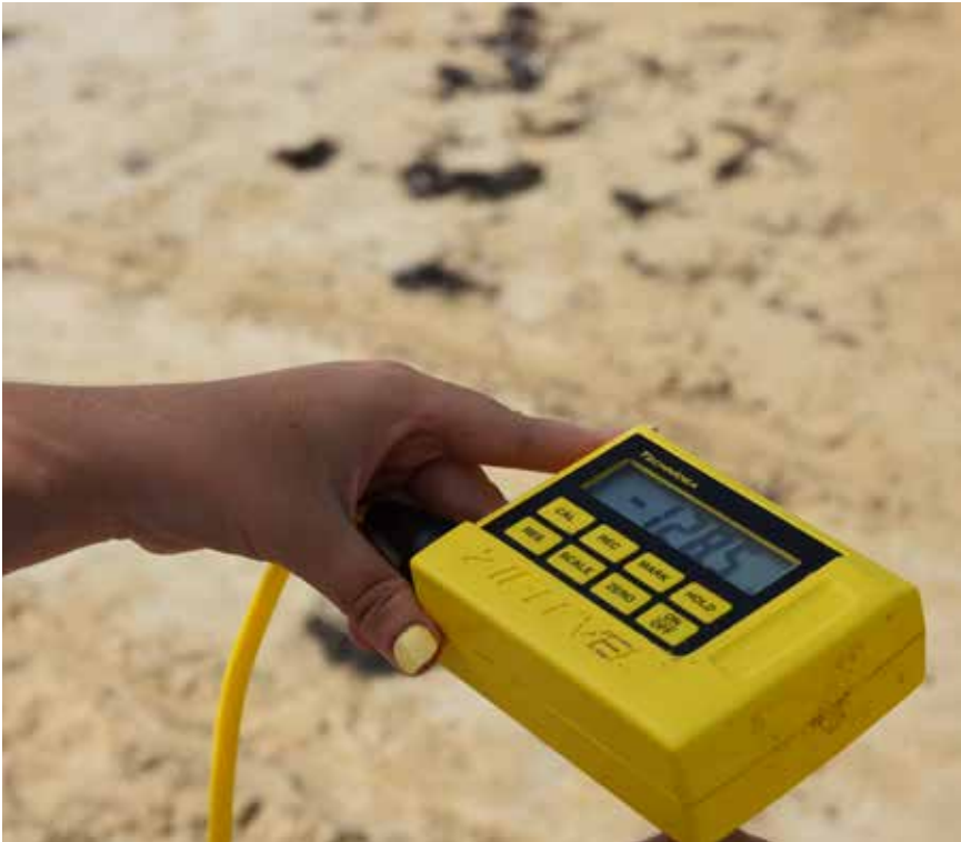
Figura 9. Utilizando el ZipLevel para realizar un perfil de playa. Foto: Jimmi Núñez.
