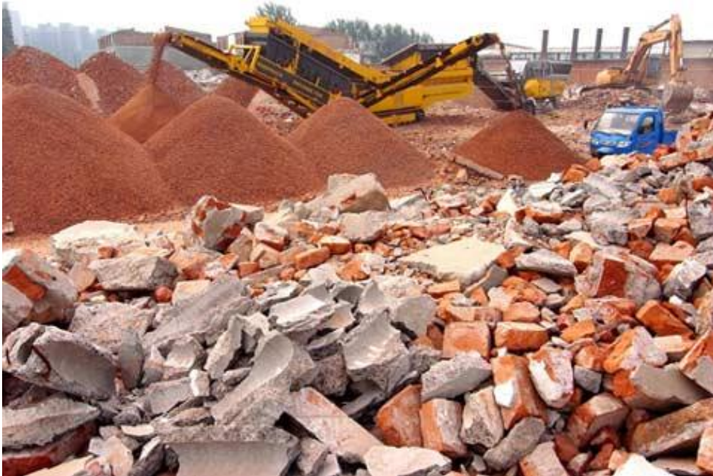
Figura 6. Trituradoras de residuos, plantas de trituración de residuos de Construcción y demolición Fuente: http://www.boliviatriTURADORA.com
