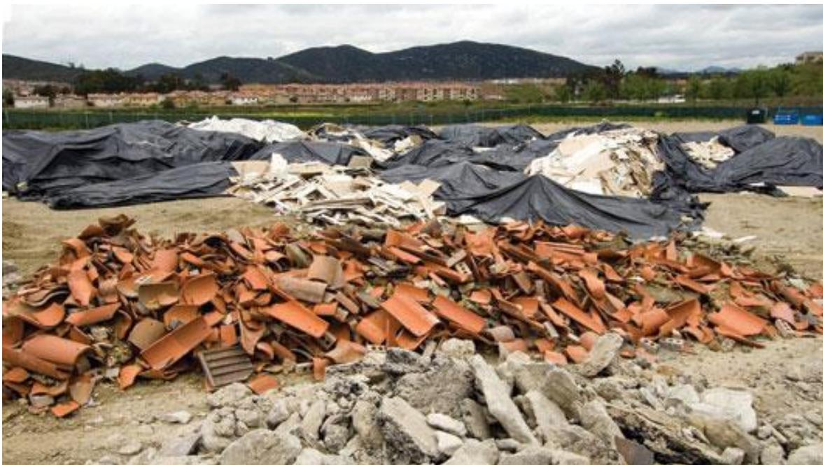
**Figura 13** Residuos de Construcción y Demolición almacenados a cielo abierto.
