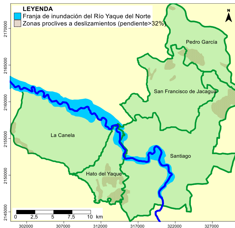
Figura 9. Áreas de riesgo de inundación y deslizamiento en el Municipio Santiago y sus Distritos Municipales. Fuentes: Mapa Nacional de inundaciones (GEOCYL, 2009) y de deslizamientos (BID, 2010).
