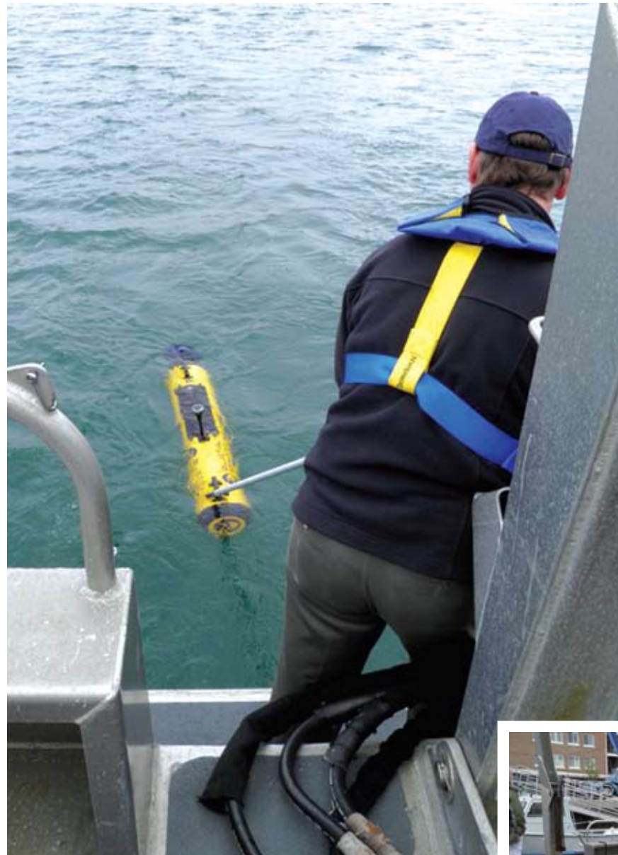
En esta foto se observa la recogida del Bluefin-9 al término de la misión de exploración.
